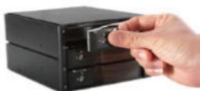
**注意:**ドライブを実際に取り外す前にコンピュータシステムからHDDを排出または取り外しておくことが大切です。「使用方法 - HDDの接続を外す」のセクションをご覧ください。
