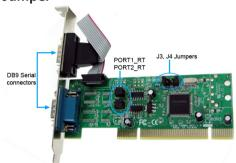
Les deux ensembles de jumpers sur cette carte (J4, J3 et PORT1\_RT, PORT2\_RT) sont utilisés pour configurer mode de fonctionnement/protocole série et le fonctionnement 2/4-fiches respectivement.
