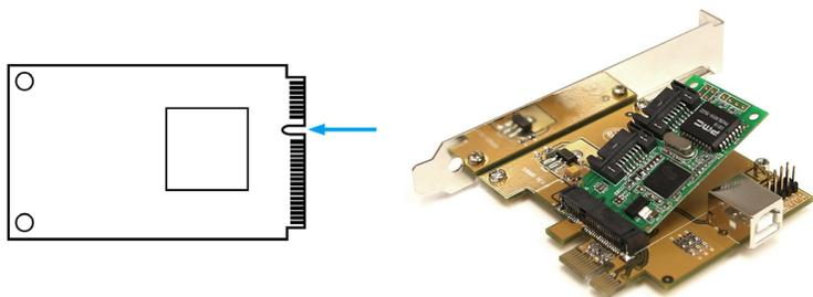
2. Une fois que la carte mini-PCIe est entièrement insérée dans la fente, poussez la carte contre la carte adaptateur. Fixez la carte mini-PCIe à la plaque avec les petites vis de fixation fournies. Veillez à ne pas trop serrer les vis, ou vous risquez d'endommager la carte mini-PCIe.
