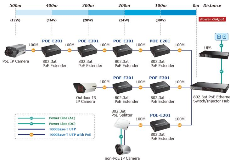
Cada unidad del extensor requiere un máximo de ~3,2 W para alimentar toda la unidad. Verifique el consumo de alimentación total de sus dispositivos y las unidades del extensor PoE, antes de establecer una configuración de conexión en cadena. Si el consumo de alimentación general está sobrecargado, el PSE local podría apagar todo el sistema de alimentación.
