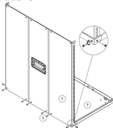
3. パネルのコーナーにある穴に沿ってプラスチック製コーナーキャップ (#4) を並べます。M3 (8 mm) 平頭プラスネジ (#6) を使ってコーナーキャップ (#4) をラックの8つのコーナーに取り付けます。
