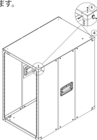
4. ラックの側面を向け、取付金具用ネジ(#11)を使ってキャスタ(#9)(#10)をラックに取り付けます。
