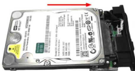
3. Depuis le dessous de l'appareil, rattachez 2 vis pour fixer le disque dur au panneau arrière.
