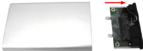
2. Fixez le disque dur sur le panneau arrière en glissant simplement le disque dur sur le connecteur SATA 7 +15 du panneau arrière.
