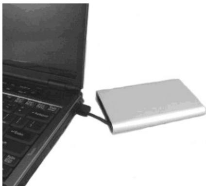
**NOTE :** Un connecteur d'alimentation DC pour adaptateur d'alimentation externe est situé sous le câble USB intégré. Ce serait nécessaire pour les disques durs ne pouvant pas tirer assez de puissance du port USB seul.
