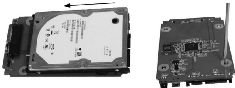
3. Une fois que le disque dur a été fixé à la carte de circuit imprimé, glissez délicatement le circuit imprimé (avec disque dur attaché), dans le logement du boîtier de disque.
