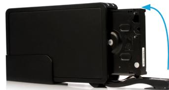
4. Empuje la puerta de la unidad, cerrándola, lo que al tiempo fijará el disco duro en el gabinete. No empuje el disco únicamente, ya que esto impedirá su instalación correcta.
