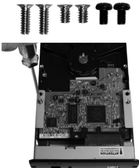
4. Sujete el panel frontal (con el disco conectado) al cuerpo del Gabinete con cuidado de manera que el disco y el panel frontal queden correctamente alineados con el cuerpo del gabinete para evitar daños a los LEDs.
