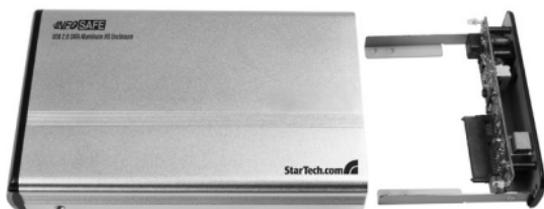
2. Posicione el disco duro que desea instalar de forma que la conexión SATA quede orientada hacia el conector de interfaz SATA ubicado en el panel frontal del gabinete:
