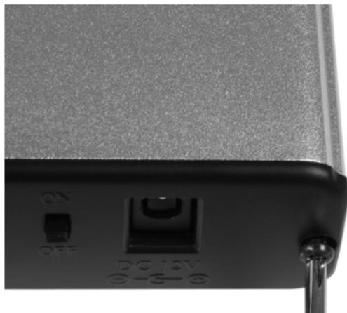
7. Una vez que el disco esté correctamente sujeto dentro del Gabinete, conecte la fuente de alimentación de 12V al puerto correspondiente y luego conecte la fuente a una toma de corriente disponible.
