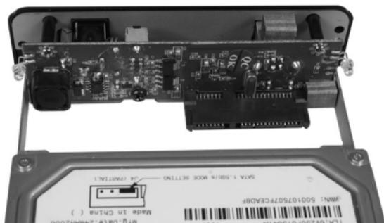
3. Una vez conectado el disco duro al panel frontal, gire el disco para exponer la base del mismo. Sujete por ambos lados al disco duro a los rieles del panel frontal utilizando los tornillos incluidos con el producto (2):
