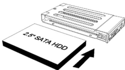
Si vous utilisez un disque plus grand que 9,5mm, alors le haut du plateau de disque doit être retiré. Desserrez la vis située près de l'arrière du plateau, puis tirez le haut du plateau. Placez le disque sur le plateau et fixez-le depuis le bas avec 4 vis (inclus).
