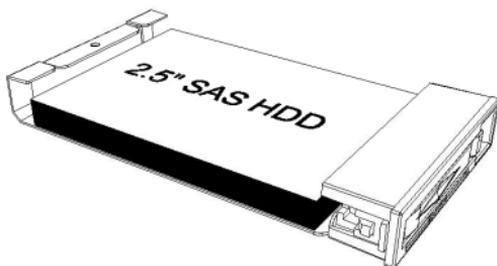
11. Faites glisser les plateaux de disque dans le fond de panier et verrouillez les plateaux en place en fermant avec la poignée tournante en vous assurant que le loquet verrouille correctement.
