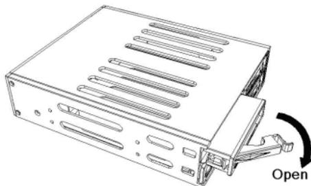
10. Si vous utilisez un lecteur de 9,5mm de hauteur, alors le haut du plateau de disque n'a pas besoin d'être enlevé. Il suffit de glisser le disque dans le bac par les côtés, puis de fixer le disque sur la face inférieure du plateau avec 4 vis (inclus).
