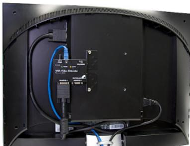
5. Conecte la salida Cat5 OUT de la Unidad Transmisora a la entrada Cat5 IN de la Unidad Extensora utilizando un cable UTP estándar con conectores RJ45 en ambos extremos.
