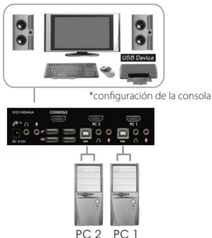
1. Conecte un monitor/dispositivo de visualización en el conector de la Consola HDMI. Conecte un teclado USB y un mouse USB en los puertos dedicados para el teclado y mouse USB en el interruptor KVM.
