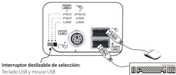
**NOTA:** Cuando se configura el interruptor como un Esclavo (slave) en una configuración de cascada, el teclado y mouse PS/2 es el único modo que puede ser utilizado. Por tanto, el artículo SV431DUSB no puede ser configurado como un esclavo en una configuración de cascada, pues no se proporciona un selector de interruptor deslizable.
